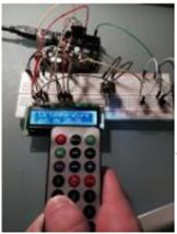
472. Capteur temperature choix du type de degres par infrarouge using arduino ENGLISH VERSION HERE Dans ce programme nous allons voir comment capter une température et afficher sa valeur sur un lecteur LCD en choisissant si on veut l'afficher en°C ou °F grâce à une télécommande infrarouge. Dans ce tuto j'utilise: - Une carte SainSmart (similaire à Arduino..... Listed under: LCD Projects
